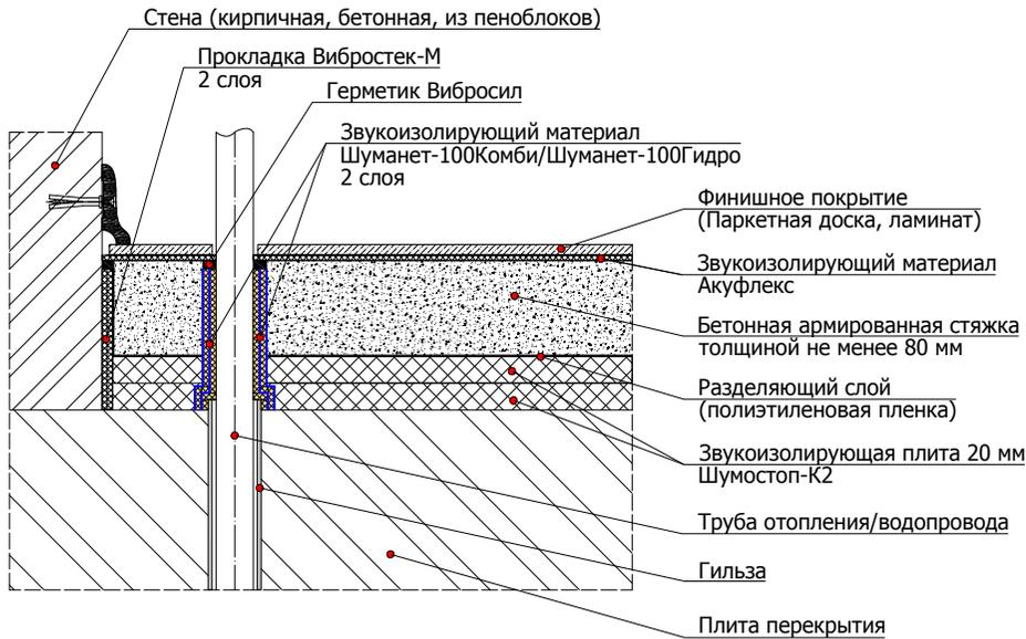
6.1.2 Схема применения материала Акуфлекс под финишным покрытием в сочетании с конструкцией плавающего пола с применением звукоизолирующего материала Шумостоп
