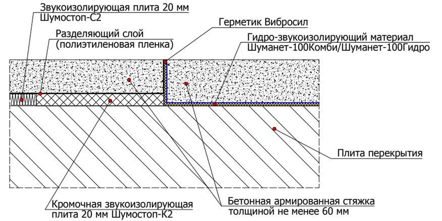
6.2.7 Схема устройства конструкции плавающего пола с применением звукоизолирующего материала Шуманет-100Комби/Шуманет-100Гидро в санузле
