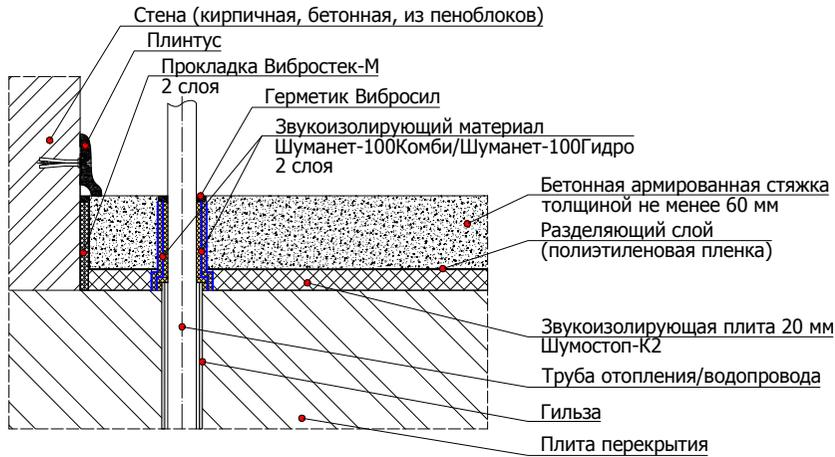
6.4.2 Схема примыкания конструкции плавающего пола с применением звукоизолирующих плит Шумостоп-K2 в один слой к стене
