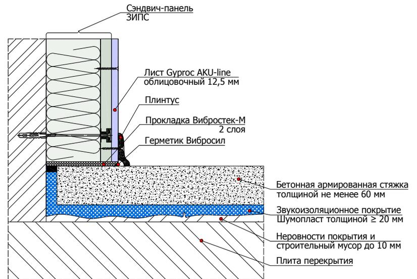
6.5.4 Схема устройства конструкции плавающего пола с коммуникациями под стяжкой с применением звукоизолирующего покрытия Шумопласт
