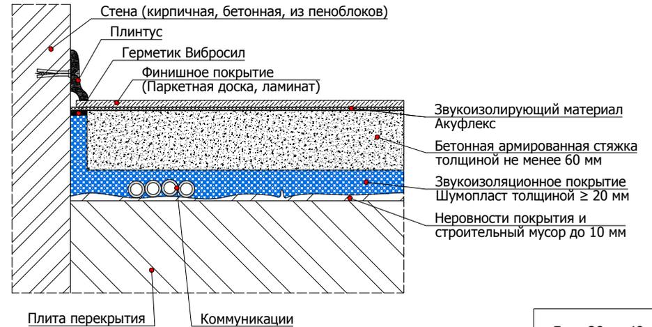
6.2.1 Схема устройства конструкции плавающего пола с применением звукоизолирующего материала Шуманет-100Комби/Шуманет-100Гидро
