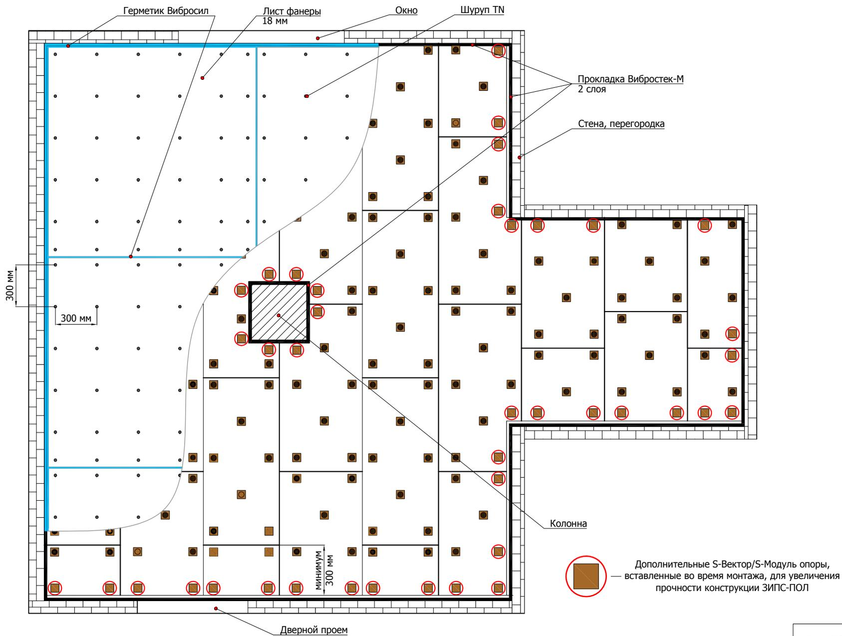
6.7.1 Схема устройства конструкции пола по деревянным лагам с применением виброизоляционного материала Sylomer
