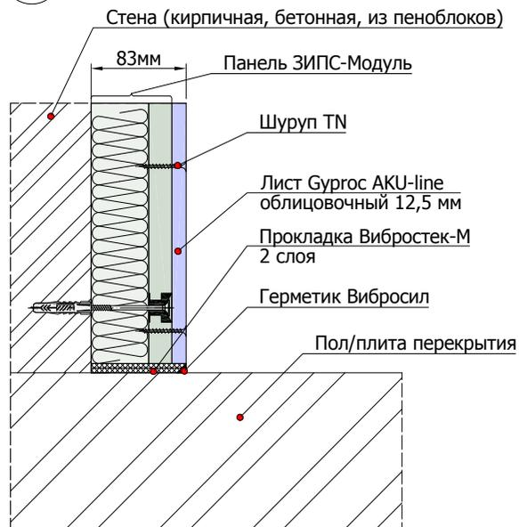
2.3.2 Примыкание панелей ЗИПС-Модуль к панелям ЗИПС-Модуль на потолочном перекрытии и подвесному звукоизолирующему потолку
