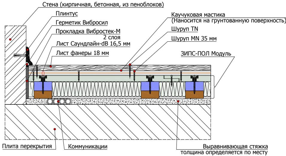
6.6.6 Схема примыкания конструкции ЗИПС-ПОЛ Модуль к панелям ЗИПС
