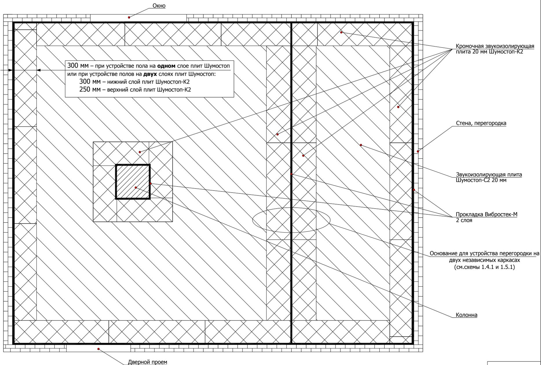
6.4.1 Схема устройства конструкции плавающего пола с применением звукоизолирующих плит Шумостоп-K2 в один слой
