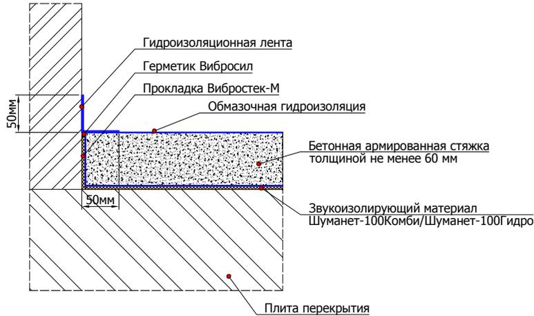
6.8.2 Схема устройства гидроизоляции в конструкции плавающего пола с применением звукоизолирующего покрытия Шумопласт
