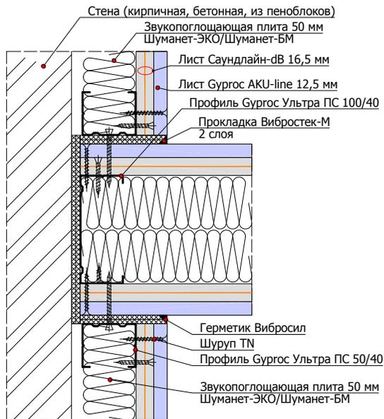
1.2.4 Примыкание перегородки на одинарном каркасе 100 мм к панелям ЗИПС на стене и дверному проему
