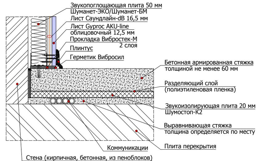
6.4.5 Схема устройства конструкции плавающего пола с применением звукоизолирующих плит Шумостоп-K2 в два слоя
