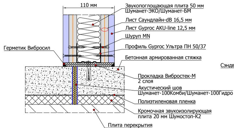
1.1.4 Примыкание перегородки на одинарном каркасе 50 мм к панелям ЗИПС на потолочном перекрытии
