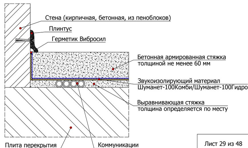
6.2.5 Схема устройства конструкции плавающего пола с применением звукоизолирующего материала Шуманет-100Комби/Шуманет-100Гидро
