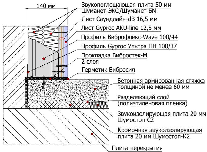
4.3.2 Примыкание облицовки стены на независимом каркасе из профилей Виброфлекс-Wave 100 мм к панелям ЗИПС на потолочном перекрытии и подвесному звукоизолирующему потолку
