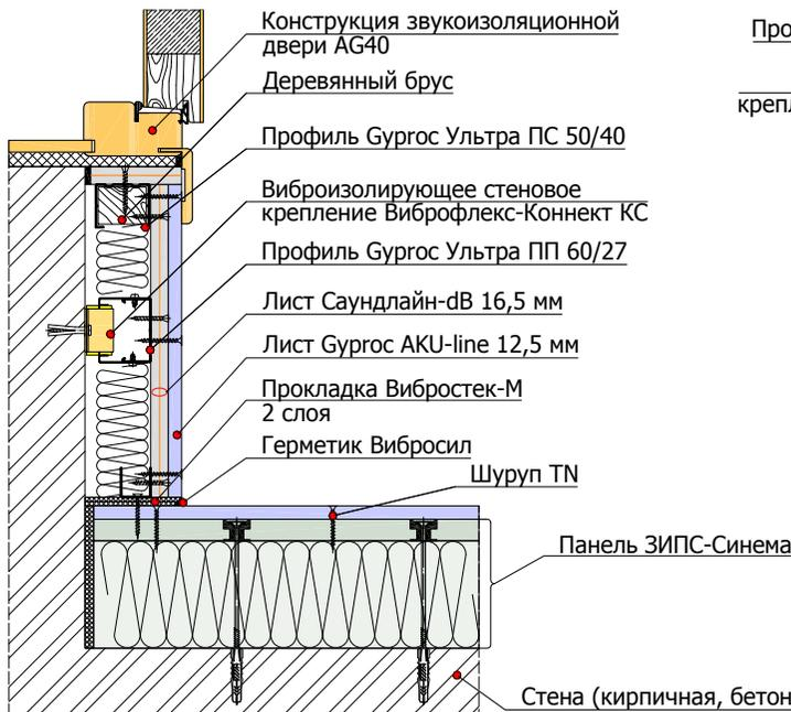
4.5.2 Примыкание облицовки стены на каркасе ПП 60/27 и виброизолирующих стеновых креплениях Виброфлекс-КС к панелям ЗИПС на потолочном перекрытии и к подвесному звукоизолирующему потолку
