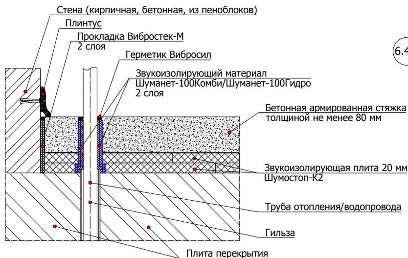
6.4.8 Схема примыкания конструкции плавающего пола с применением звукоизолирующих плит Шумостоп-K2 в два слоя к стене и коммуникациями под стяжкой
