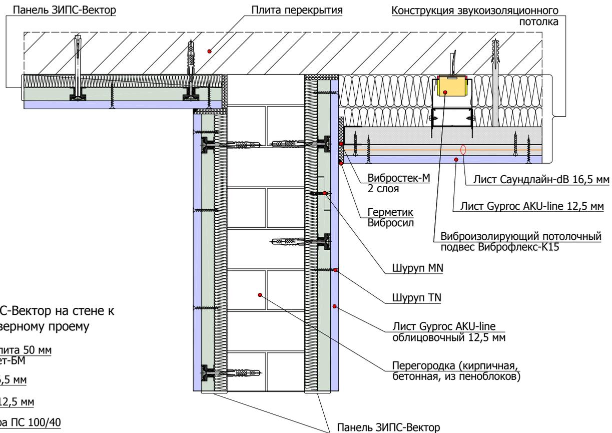
2.2.3 Угловое примыкание панелей ЗИПС-Вектор на стене к облицовке на каркасе 100 мм и дверному проему
