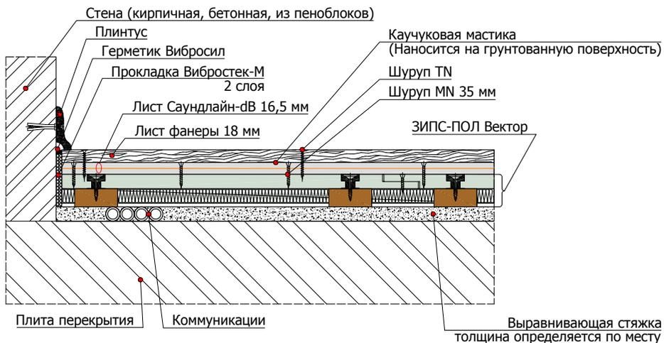
6.6.2 Схема примыкания конструкции ЗИПС-ПОЛ Вектор к панелям ЗИПС
