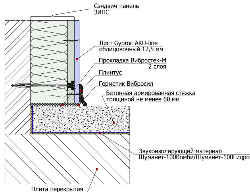
6.2.3 Схема примыкания конструкции плавающего пола с применением звукоизолирующего материала Шуманет-100Комби/Шуманет-100Гидро к стене и трубе отопления/водопровода
