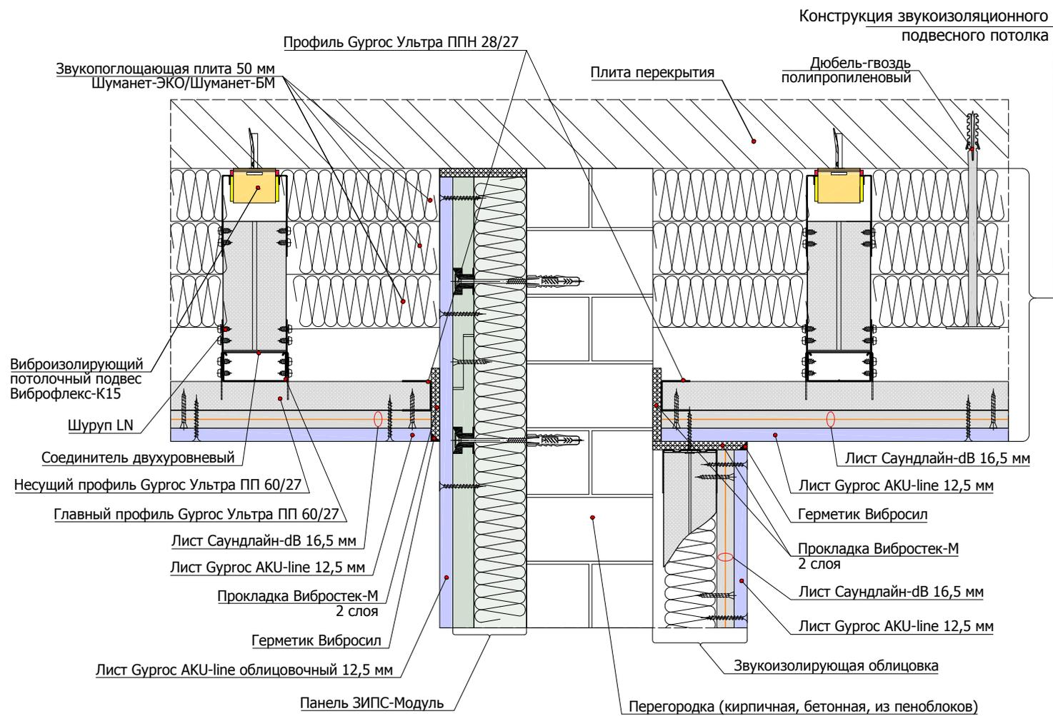
5.4.1 Подвесной потолок на виброизолирующих потолочных подвесах Виброфлекс-К15 (узлы скользящего соединения потолка с облицовками стен). Способ исполнения конструкции в деревянном доме
