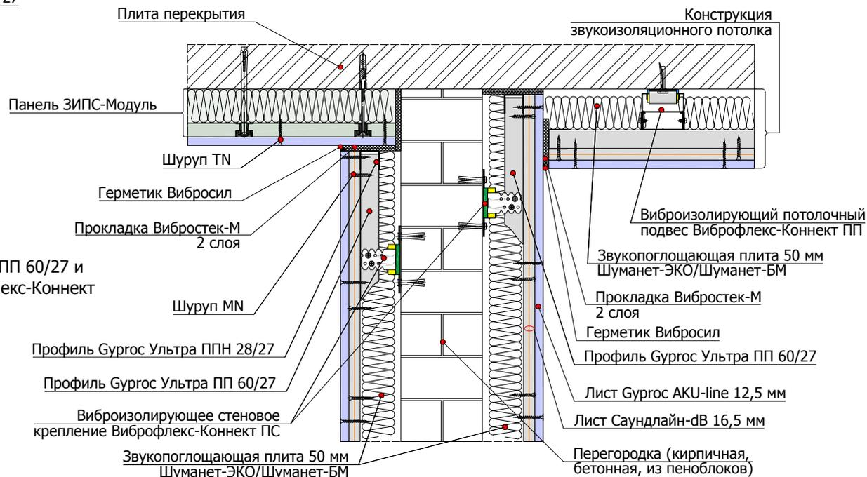
4.4.3 Угловое примыкание облицовки стены на каркасе ПП 60/27 и виброизолирующих стеновых креплениях Виброфлекс-Коннект ПС к панелям ЗИПС на стене и дверному проему
