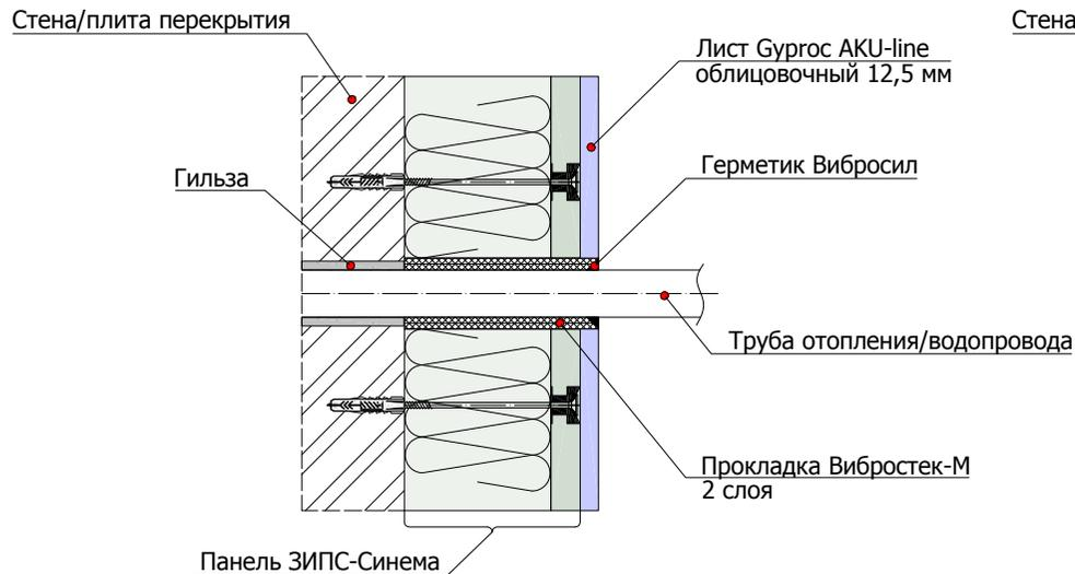
8.4.4 Схема пропуска труб отопления/водопровода через конструкцию панельной системы ЗИПС-III-Ультра
