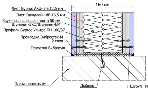
1.2.2 Примыкание перегородки на одинарном каркасе 100 мм к стене и дверному проему
