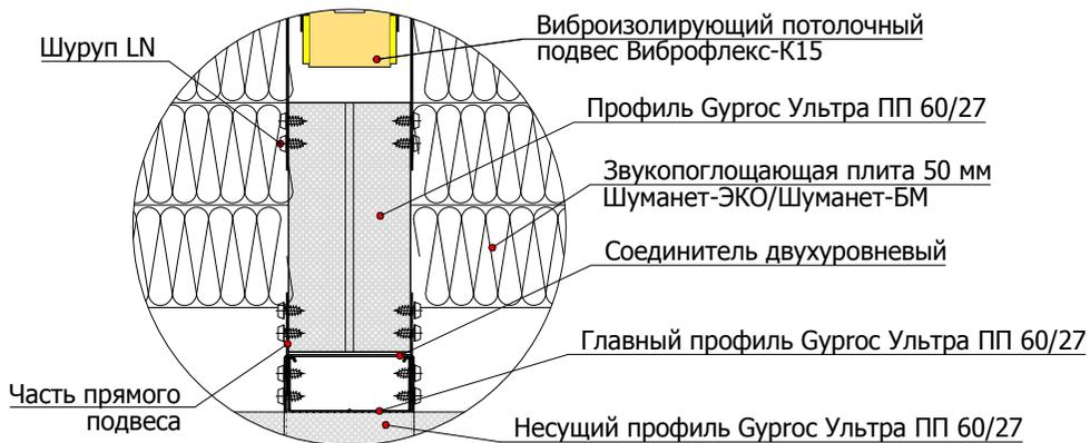
5.3.3 Примыкание звукоизоляционного подвесного потолка, выполненного на виброизолирующих потолочных подвесах Виброфлекс-K15 к облицовкам стен. Конструкция на удлинительях из профилей ПП 60/27
