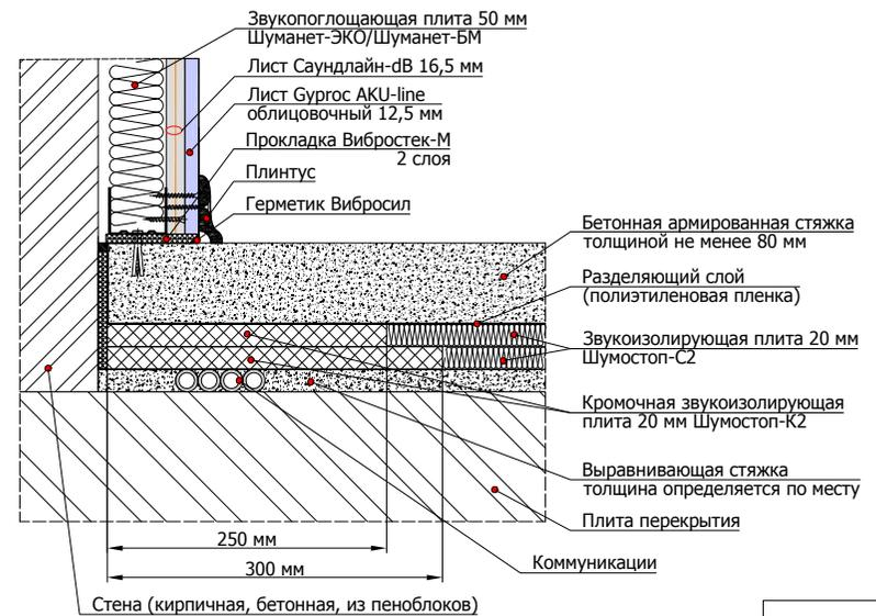
6.3.9 Схема устройства конструкции звукоизоляционного пола плавающего типа с применением звукоизолирующих плит Шумостоп (вид в плане)
