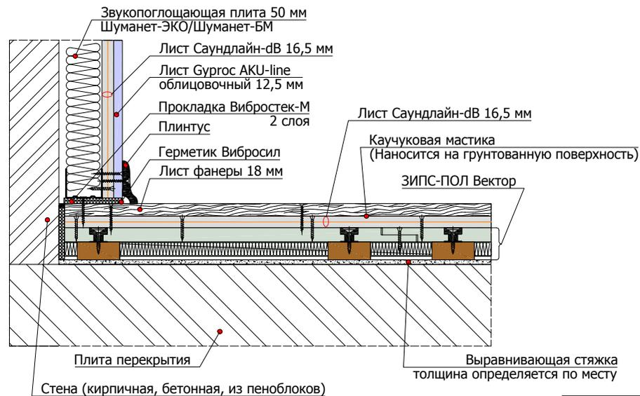
6.6.5 Схема устройства конструкции ЗИПС-ПОЛ Модуль
