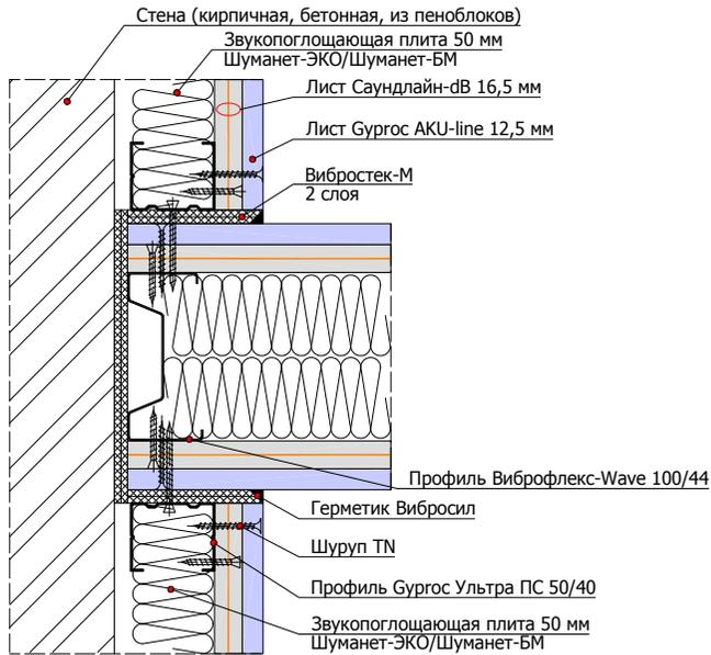
1.3.2 Примыкание перегородки на одинарном каркасе из профилей Виброфлекс-Wave 100 мм к панелям ЗИПС на стене и дверному проему
