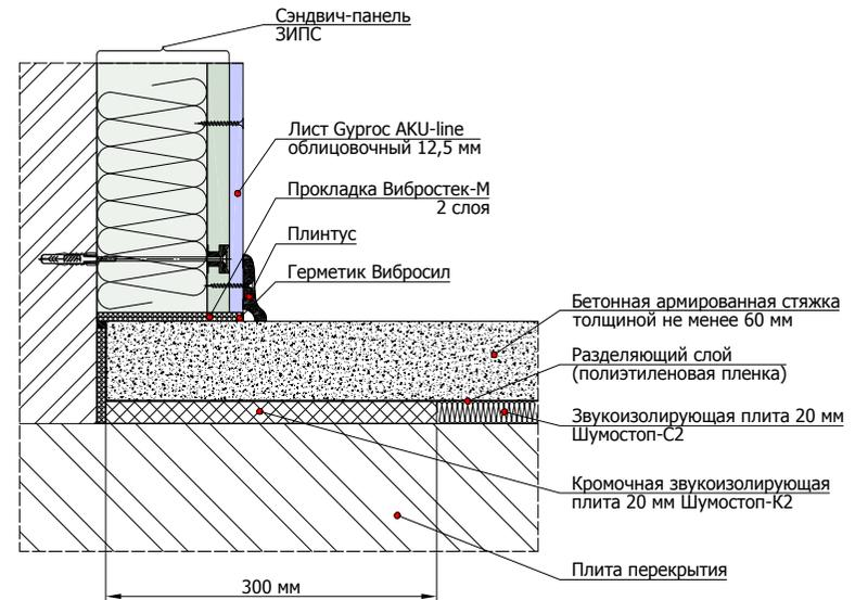
6.3.3 Схема примыкания конструкции плавающего пола с применением звукоизолирующих плит Шумостоп в один слой к стене и трубе отопления/водопровода
