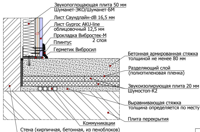
6.5.1 Схема устройства конструкции плавающего пола с применением звукоизолирующего покрытия Шумопласт
