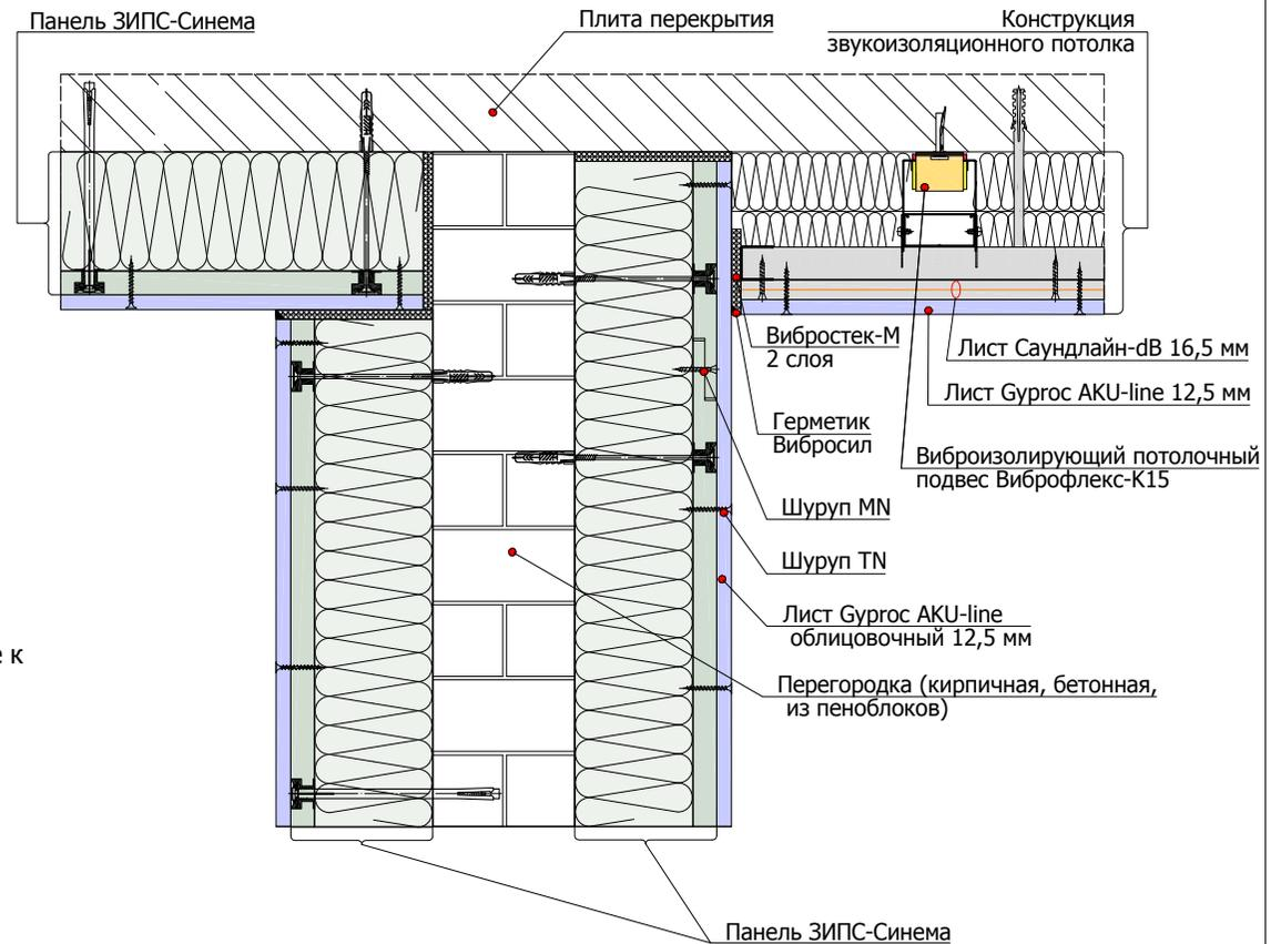
2.4.3 Угловое примыкание панелей ЗИПС-Синема на стене к облицовке на каркасе 100 мм и дверному проему
