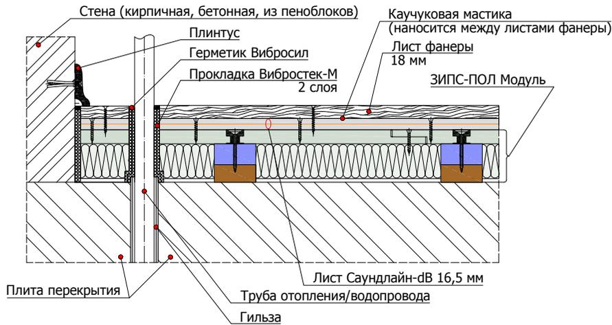
6.6.8 Схема примыкания конструкции ЗИПС-ПОЛ Модуль к каркасной облицовке
