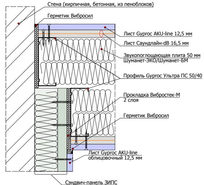
2.1.1 Схема монтажа звукоизолирующей панельной системы ЗИПС
