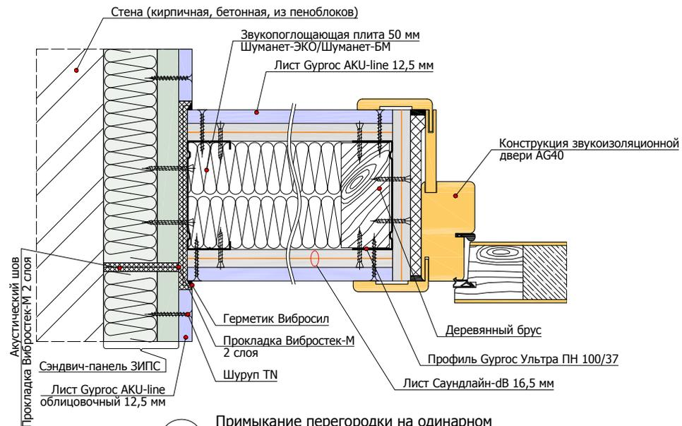
1.2.5 Примыкание перегородки на одинарном каркасе 100 мм к конструкции "плавающего" пола
