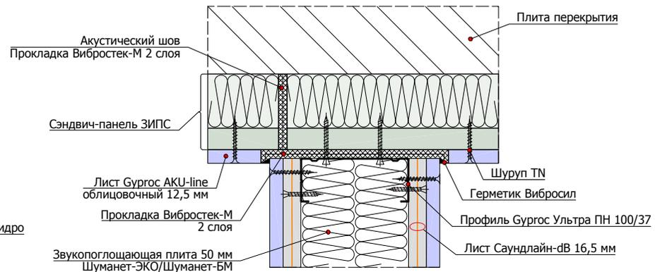
1.3.5 Примыкание перегородки на одинарном каркасе из профилей Виброфлекс-Wave 100 мм к перекрытию пола/потолка
