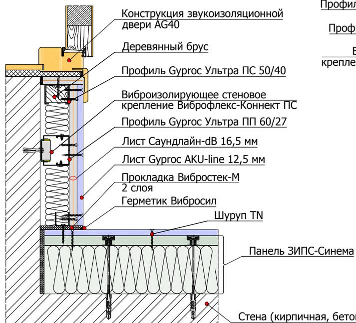
4.5.1 Примыкание облицовки стены на каркасе ПП 60/27 и виброизолирующих стеновых креплениях Виброфлекс-КС к конструкции "плавающего" пола
