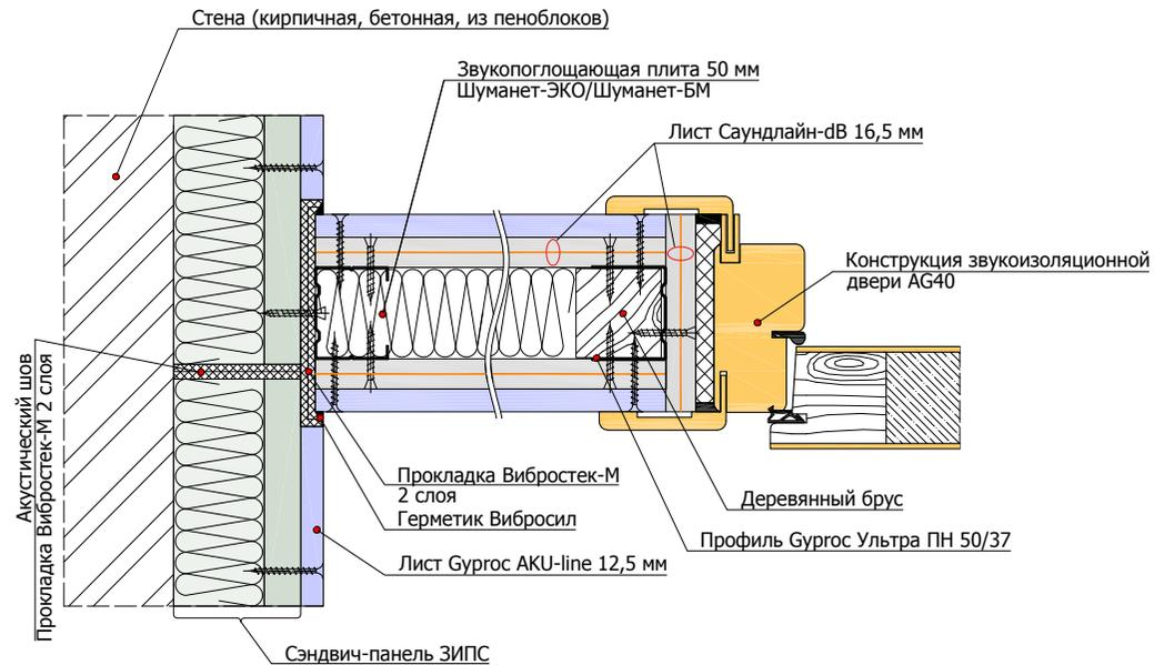
1.1.3 Примыкание перегородки на одинарном каркасе 50 мм к конструкции "плавающего" пола
