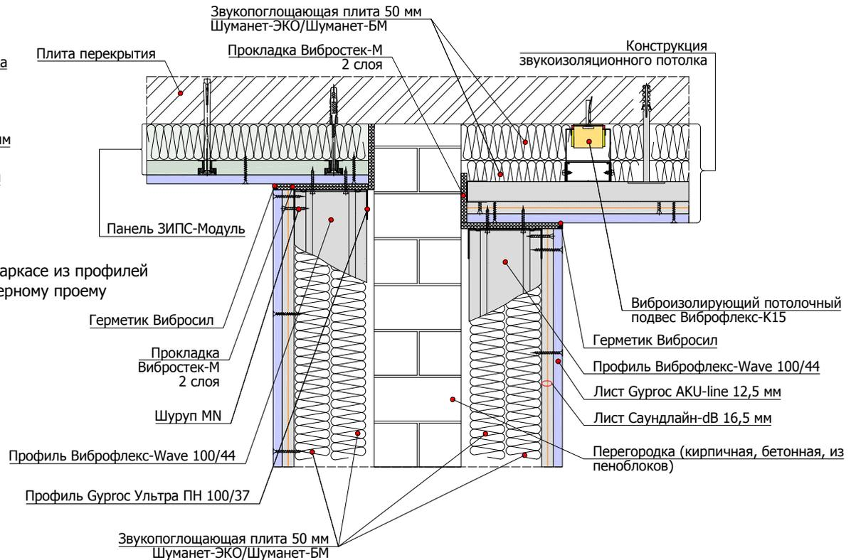
4.3.3 Угловое примыкание облицовки стены на независимом каркасе из профилей Виброфлекс-Wave 100 мм к панелям ЗИПС на стене и дверному проему
