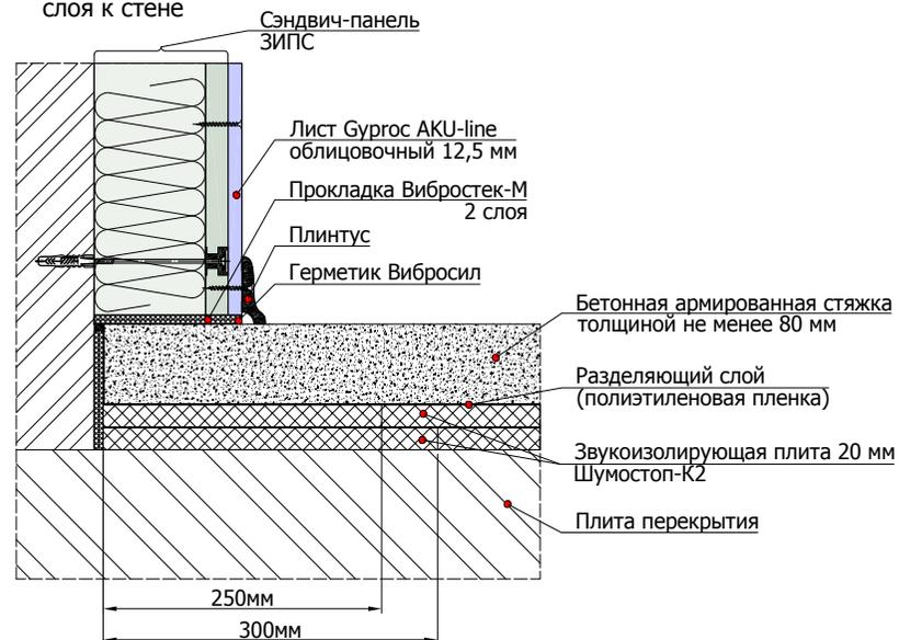
6.4.7 Схема примыкания конструкции плавающего пола с применением звукоизолирующих плит Шумостоп-K2 в два слоя к стене и трубе отопления/водопровода
