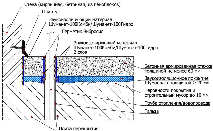
6.5.2 Схема примыкания конструкции плавающего пола с применением звукоизолирующего покрытия Шумопласт к стене
