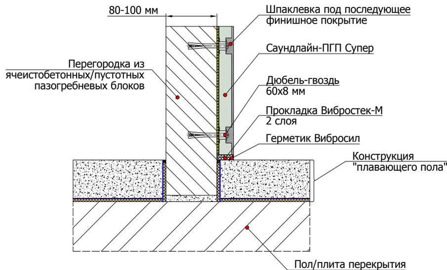
3.2 Монтаж панелей Саундлайн-ПГП Супер на перегородки из полнотелых гипсовых пазогребневых блоков и их примыкание к конструкции "плавающего пола"
