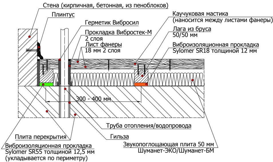
6.7.4 Схема примыкания конструкции пола по деревянным лагам с применением виброизоляционного материала Sylomer к каркасной облицовке
