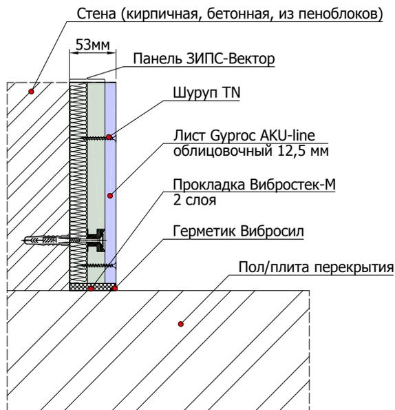
2.2.2 Примыкание панелей ЗИПС-Вектор к панелям ЗИПС-Вектор на потолочном перекрытии и подвесному звукоизолирующему потолку
