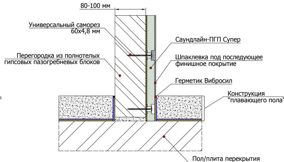
4.1.1 Примыкание облицовки стены на независимом каркасе 50 мм к конструкции "плавающего" пола
