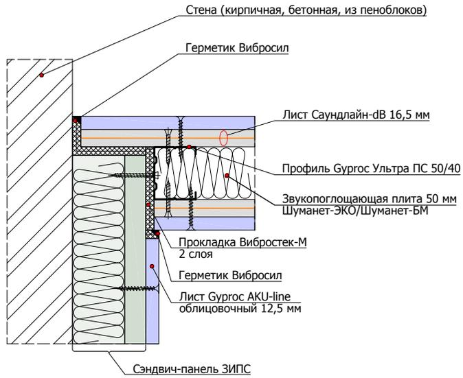
1.6.2 Угловое примыкание перегородки на одинарном каркасе 100 мм к панелям ЗИПС на стене
