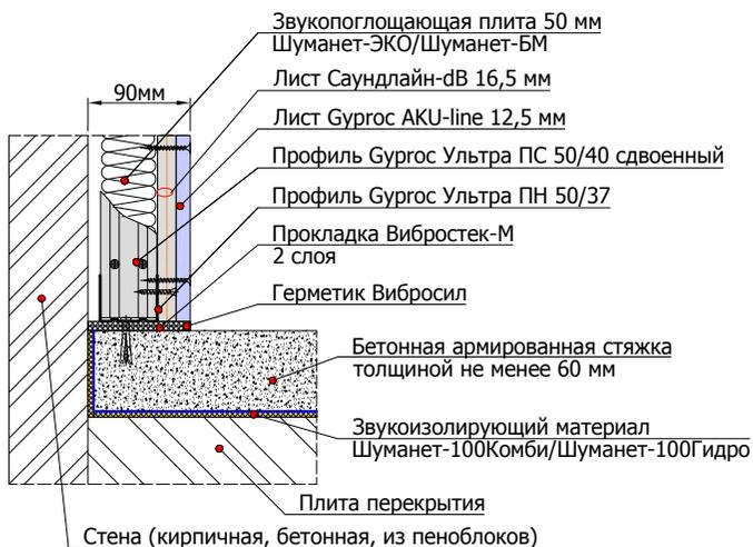
4.2.3 Монтаж облицовки стены на независимом сдвоенном каркасе 50 мм на внутренний угол и примыкание к дверному проему
