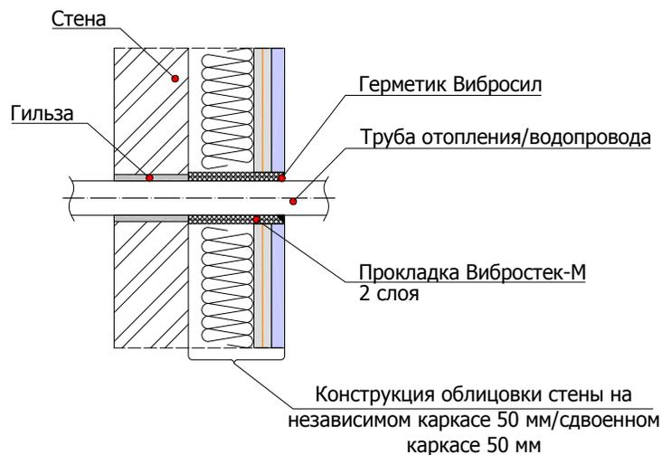
8.5.2 Схема пропуска труб отопления/водопровода через конструкцию облицовки на независимом каркасе 100 мм/Виброфлекс-Wave 100 мм
