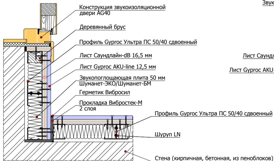
4.2.2 Примыкание облицовки стены на независимом сдвоенном каркасе 50 мм к панелям ЗИПС на потолочном перекрытии и подвесному звукоизоляционному потолку
