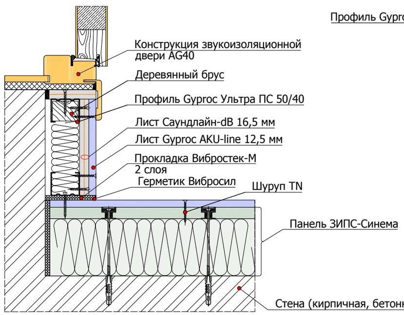
4.2.1 Примыкание облицовки стены на независимом сдвоенном каркасе 50 мм к конструкции "плавающего" пола
