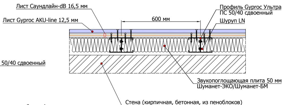
4.3.1 Примыкание облицовки стены на независимом каркасе из профилей Виброфлекс-Wave 100 мм к конструкции "плавающего" пола
