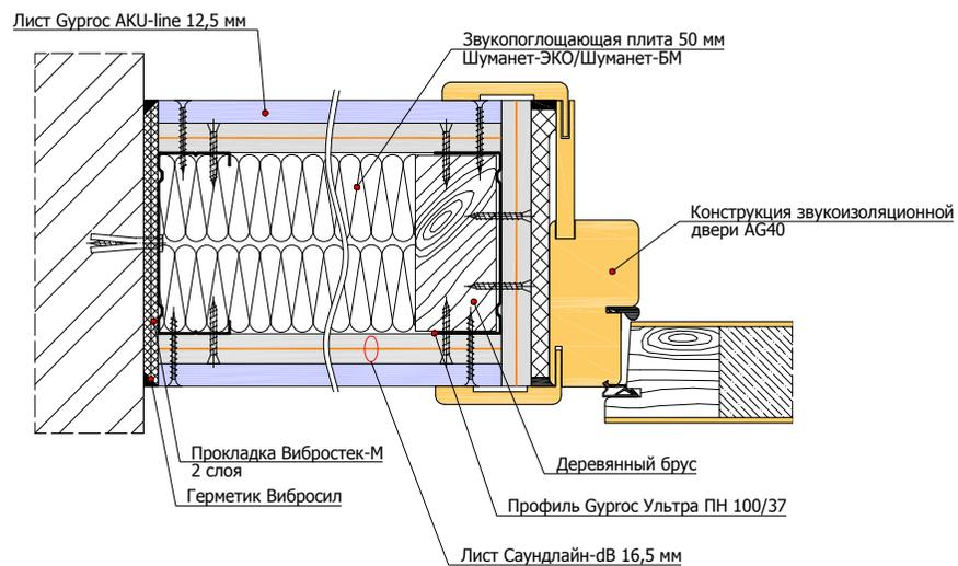
1.2.3 Примыкание перегородки на одинарном каркасе 100 мм к облицовке стен
