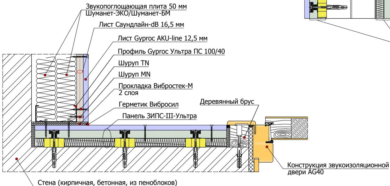
3.1 Монтаж панелей Саундлайн-ПГП Супер на перегородки из ячеистобетонных/пустотных пазогребневых блоков и их примыкание к конструкции "плавающего пола"
