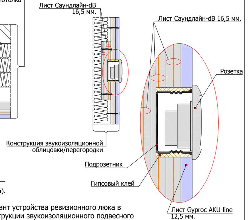
8.1.2 Вариант устройства ревизионного люка в конструкции звукоизоляционного подвесного потолка
