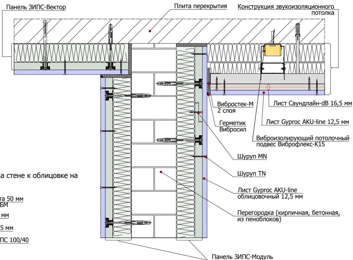
2.3.3 Угловое примыкание панелей ЗИПС-Модуль на стене к облицовке на каркасе 100 мм и дверному проему
