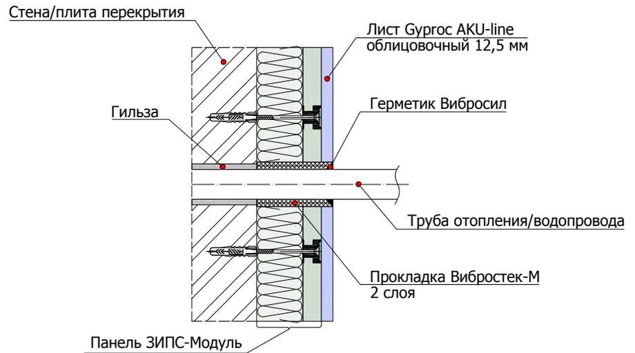
8.4.3 Схема пропуска труб отопления/водопровода через конструкцию панельной системы ЗИПС-Синема
