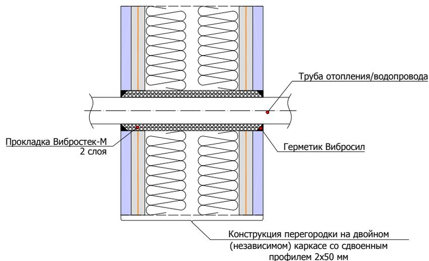
8.3.4 Схема пропуска труб отопления/водопровода через конструкцию перегородки на двойном (независимом) каркасе 2x100 мм
