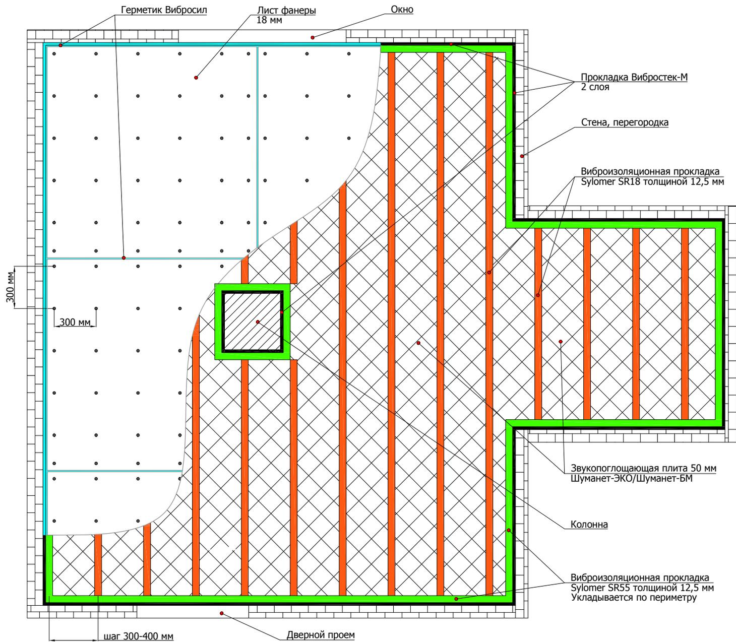
6.8.1 Схема устройства гидроизоляции в конструкции плавающего пола с применением звукоизолирующего материала Шуманет-100Комби/Шуманет-100Гидро
