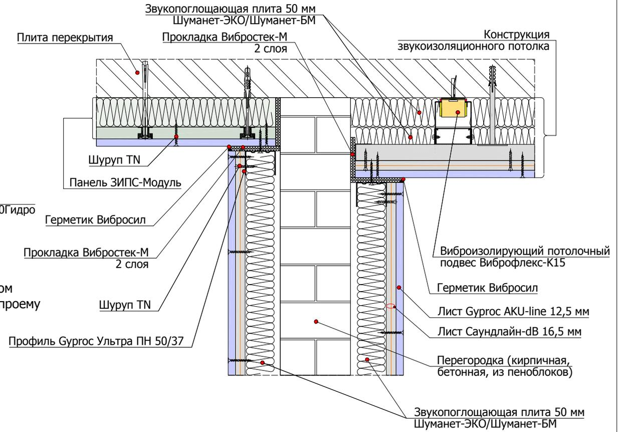
4.1.3 Угловое примыкание облицовки стены на независимом каркасе 50 мм к панелям ЗИПС на стене и дверному проему
