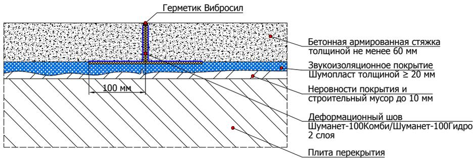
6.5.3 Схема примыкания конструкции плавающего пола с применением звукоизолирующего покрытия Шумопласт к стене и трубе отопления/водопровода
