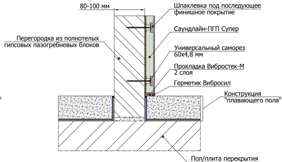
3.3 Примыкание конструкции "плавающего пола" к панелям Саундлайн-ПГП Супер, смонтированным на перегородку из ячеистобетонных/пустотных пазогребневых блоков
