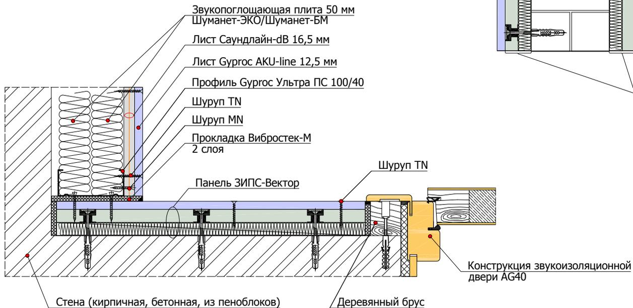
2.3.1 Примыкание панелей ЗИПС-Модуль к перекрытию пола/ потолка
