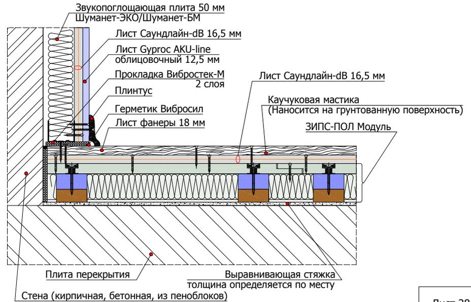
6.6.9 Схема устройства конструкции звукоизоляционного пола "плавающего" типа с применением звукоизолирующих панелей ЗИПС-ПОЛ (вид в плане)
