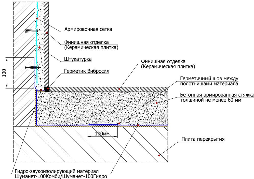
6.2.8 Схема примыкания конструкции плавающего пола с применением звукоизолирующего материала Шуманет-100Комби/Шуманет-100Гидро к стене
