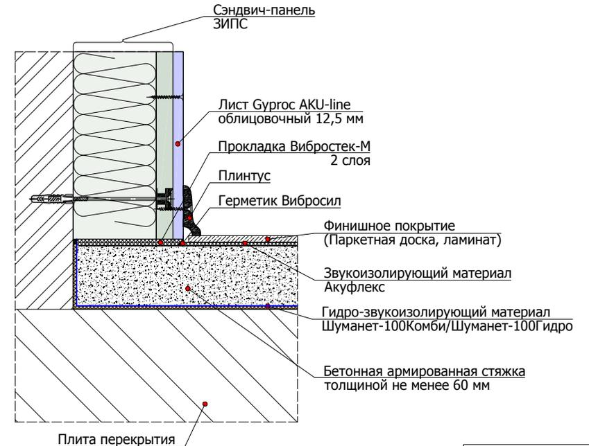
6.3.1 Схема устройства конструкции плавающего пола с применением звукоизолирующих плит Шумостоп в один слой
