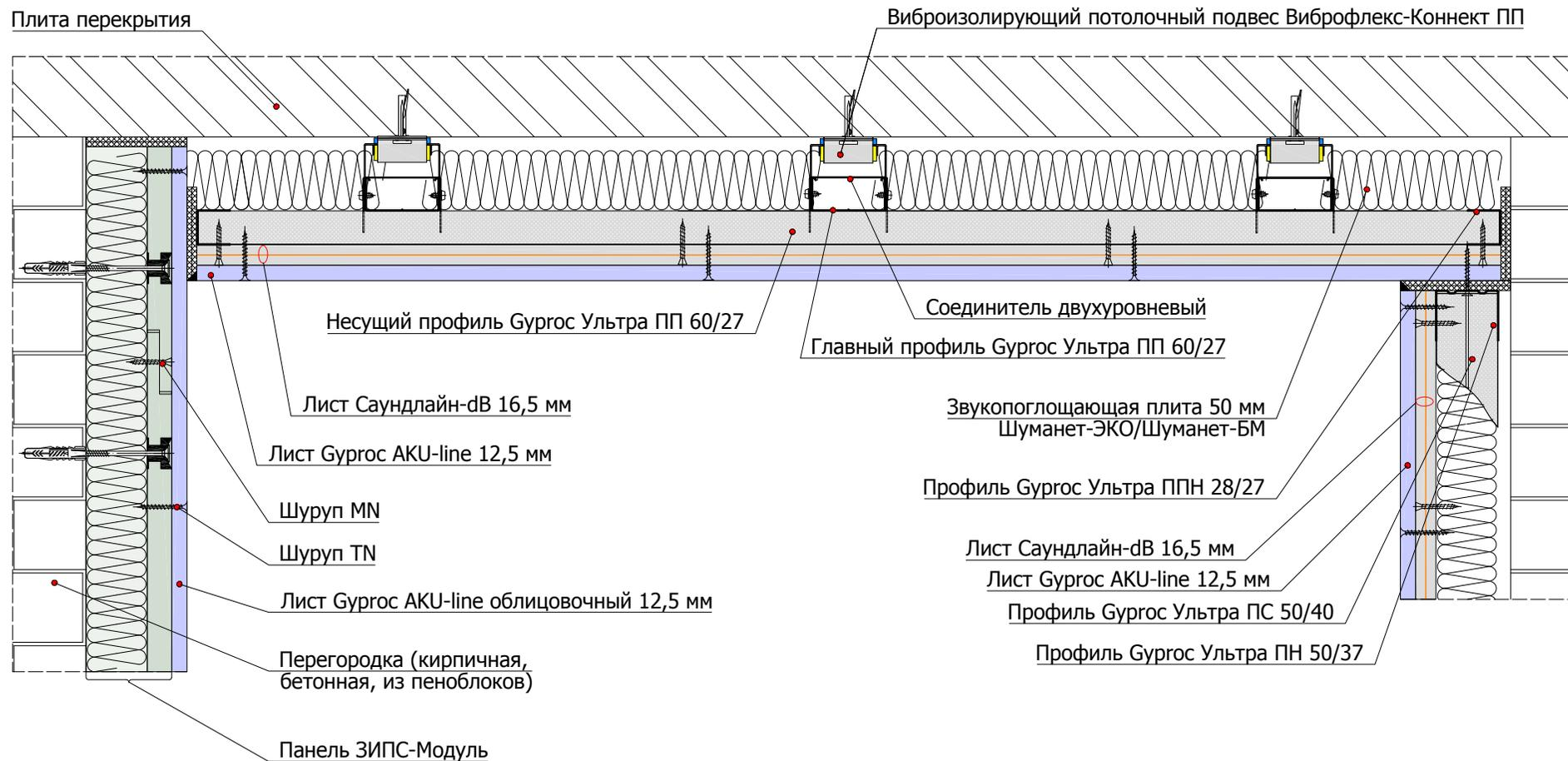
5.1.2 Примыкание звукоизоляционного подвесного потолка, выполненного на виброизолирующих потолочных подвесах Виброфлекс-Коннект ПП, к облицовкам стен
