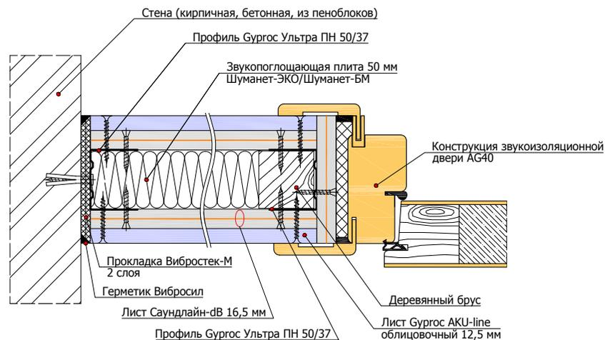
1.2.1 Примыкание перегородки на одинарном каркасе 100 мм к перекрытию пола/потолка
