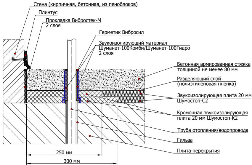
6.3.8 Схема примыкания конструкции плавающего пола с применением звукоизолирующих плит Шумостоп в два слоя к стене и коммуникациями под стяжкой
