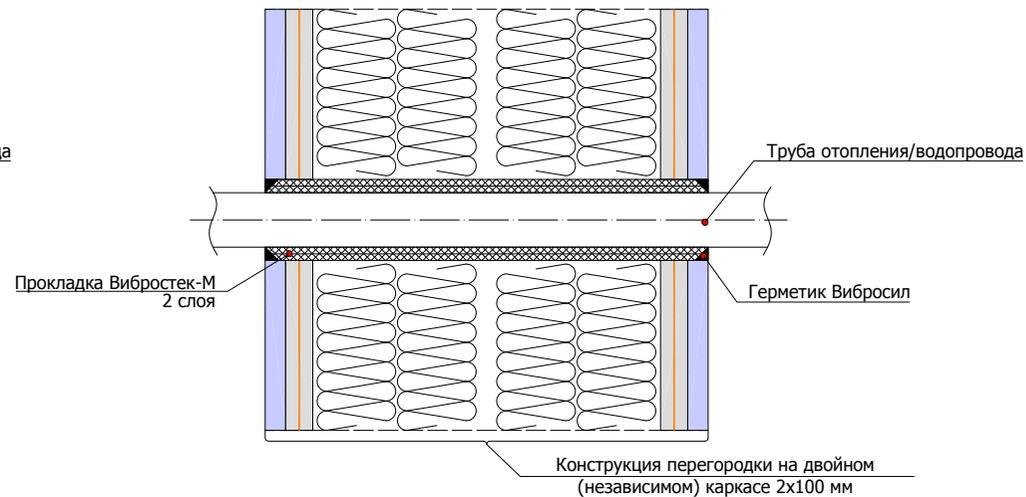
8.4.1 Схема пропуска труб отопления/водопровода через конструкцию панельной системы ЗИПС-Вектор
