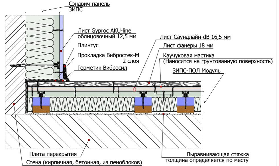
6.6.7 Схема примыкания конструкции ЗИПС-ПОЛ Модуль к стене и трубе отопления/водопровода (монтаж на ровное перекрытие)
