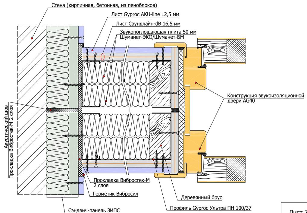
1.6.1 Угловое примыкание перегородки на одинарном каркасе 50 мм к панелям ЗИПС на стене
