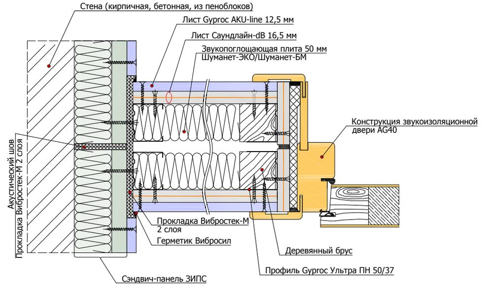
1.4.5 Перегородка на двойном 2x50 мм (сдвоенном независимом) каркасе горизонтальный разрез
