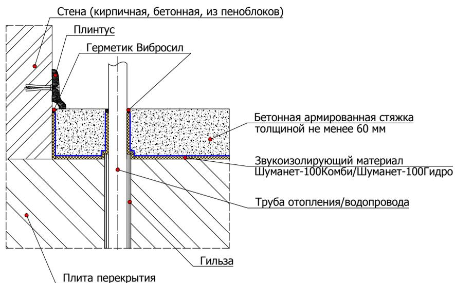
6.2.4 Схема примыкания конструкции плавающего пола с применением звукоизолирующего материала Шуманет-100Комби/Шуманет-100Гидро к стене и коммуникациями под стяжкой
