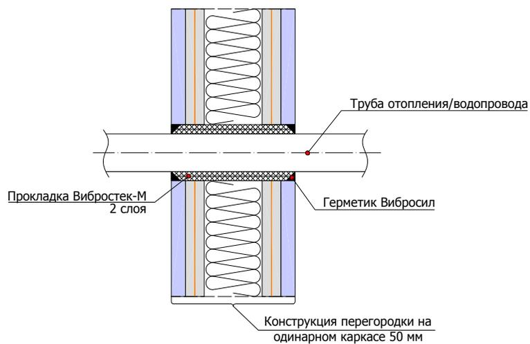
8.3.2 Схема пропуска труб отопления/водопровода через конструкцию перегородки на одинарном каркасе 100 мм/Виброфлекс-Wave 100 мм
