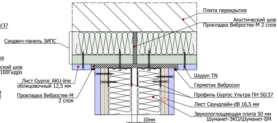
1.4.3 Примыкание перегородки на двойном 2x50 мм (сдвоенном независимом) каркасе к облицовке стен
