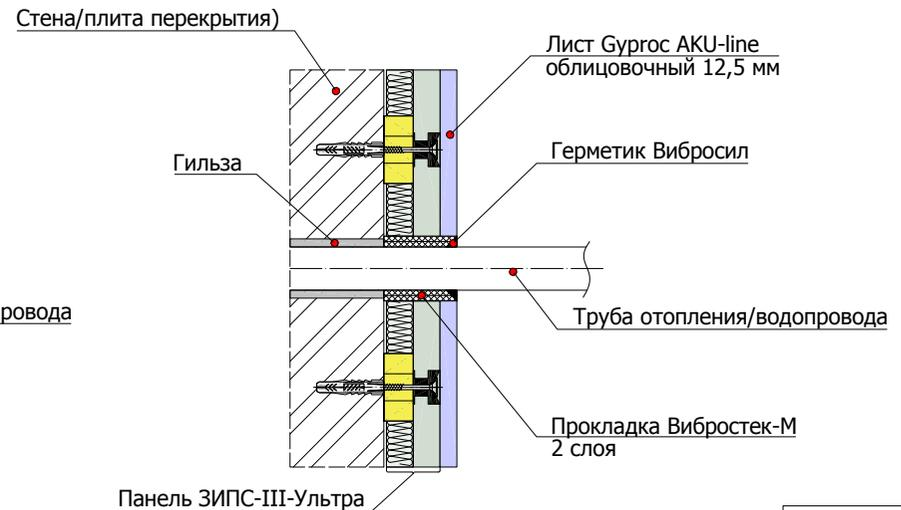
8.5.1 Схема пропуска труб отопления/водопровода через конструкцию облицовки на независимом каркасе 50 мм/сдвоенном каркасе 50 мм
