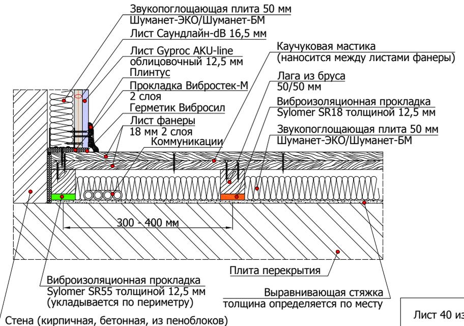
6.7.5 Схема устройства конструкции звукоизоляционного пола "плавающего" типа по деревянным лагам с применением виброизоляционного материала Sylomer (вид в плане)
