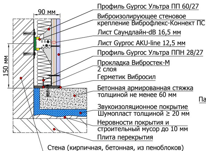
4.4.2 Примыкание облицовки стены на каркасе ПП 60/27 и виброизолирующих стеновых креплениях Виброфлекс-Коннект ПС к панелям ЗИПС на потолочном перекрытии и к подвесному звукоизолирующему потолку
