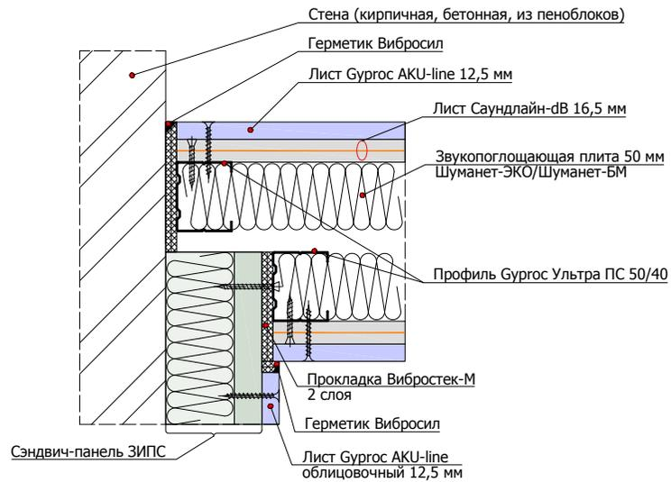
1.6.4 Угловое примыкание перегородки на двойном 2x100 мм (независимом) каркасе к панелям ЗИПС на стене
