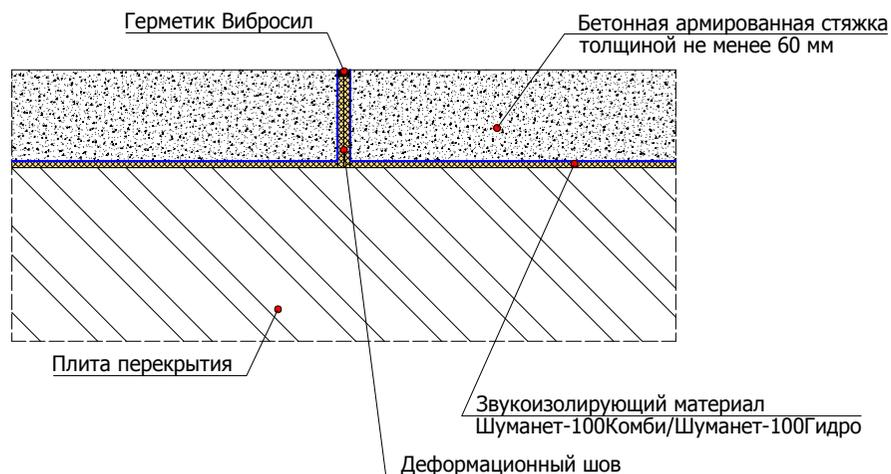
6.2.2 Схема примыкания конструкции плавающего пола с применением звукоизолирующего материала Шуманет-100Комби/Шуманет-100Гидро к стене
