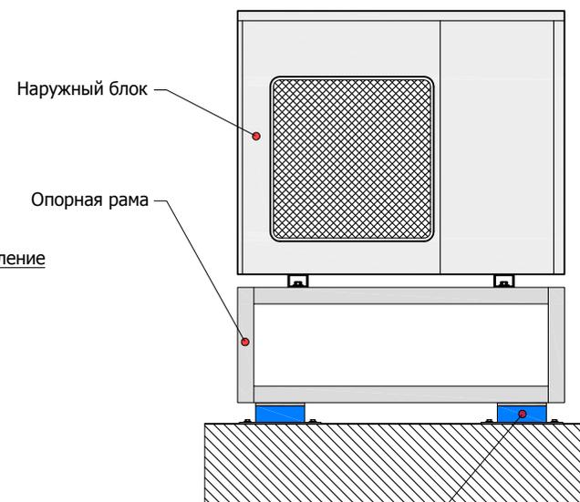
Виброизоляционная опора Виброфлекс SM
