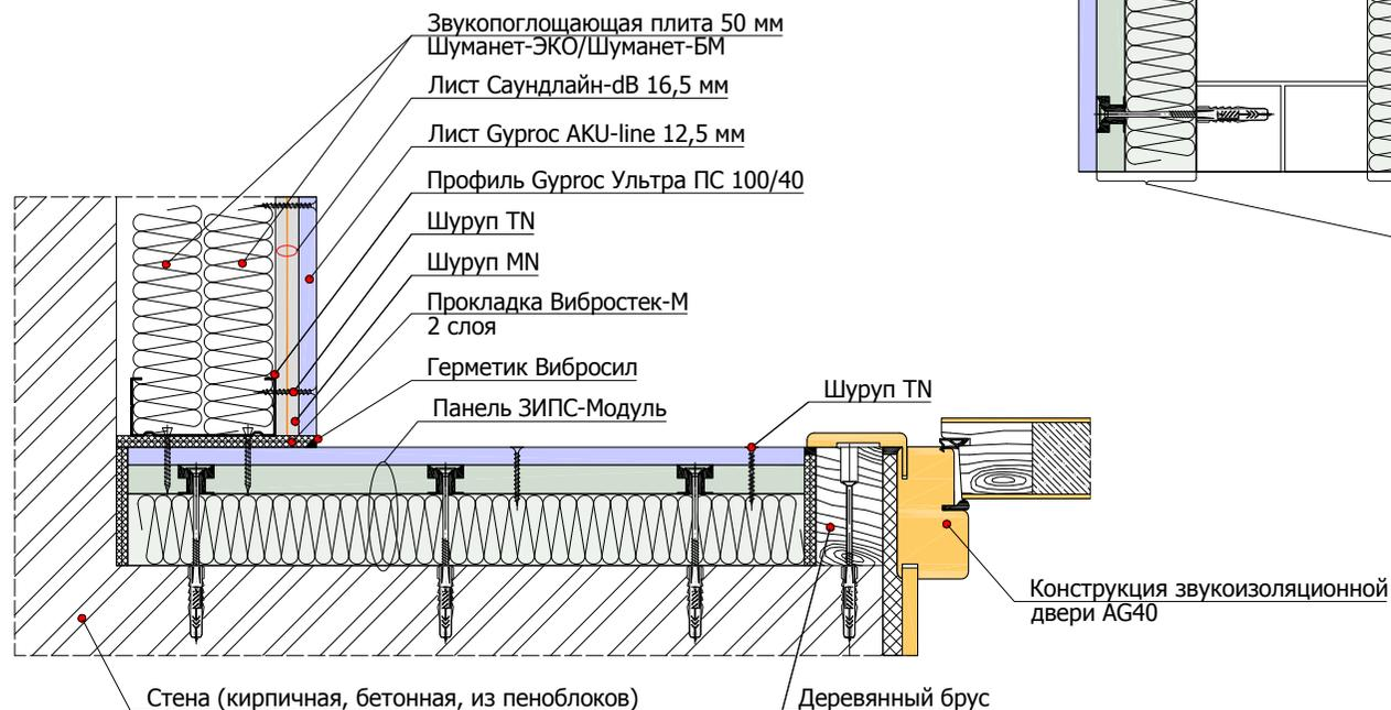
2.4.1 Примыкание панелей ЗИПС-Синема к перекрытию пола/потолка
