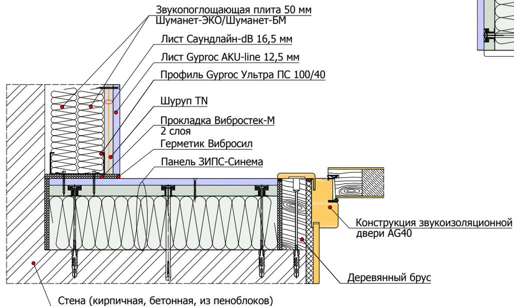
2.5.1 Примыкание панелей ЗИПС-III-Ультра к перекрытию пола/потолка
