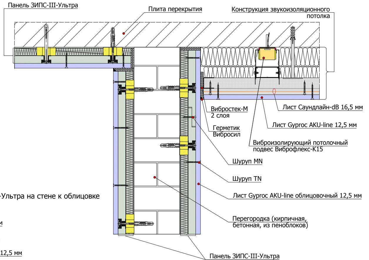
2.5.3 Угловое примыкание панелей ЗИПС-III-Ультра на стене к облицовке на каркасе 100 мм и дверному проему
