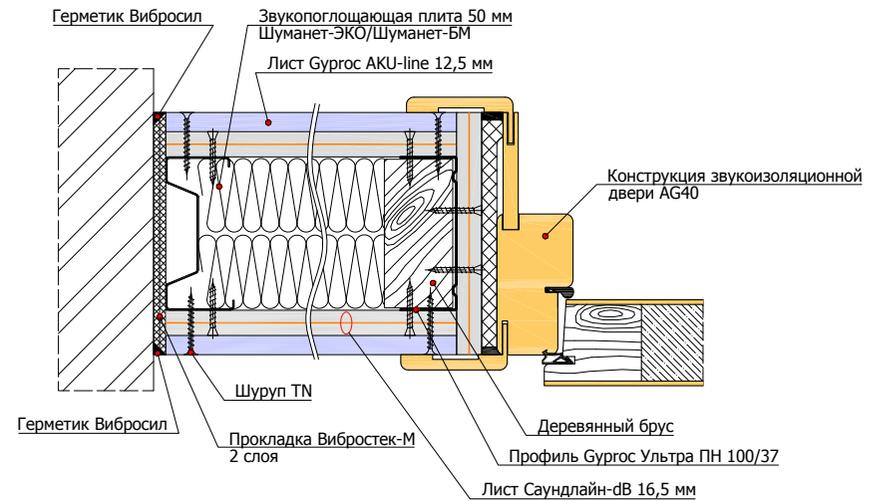
1.4.1 Примыкание перегородки на двойном 2x50 мм (независимом сдвоенном) каркасе к конструкции "плавающего" пола
