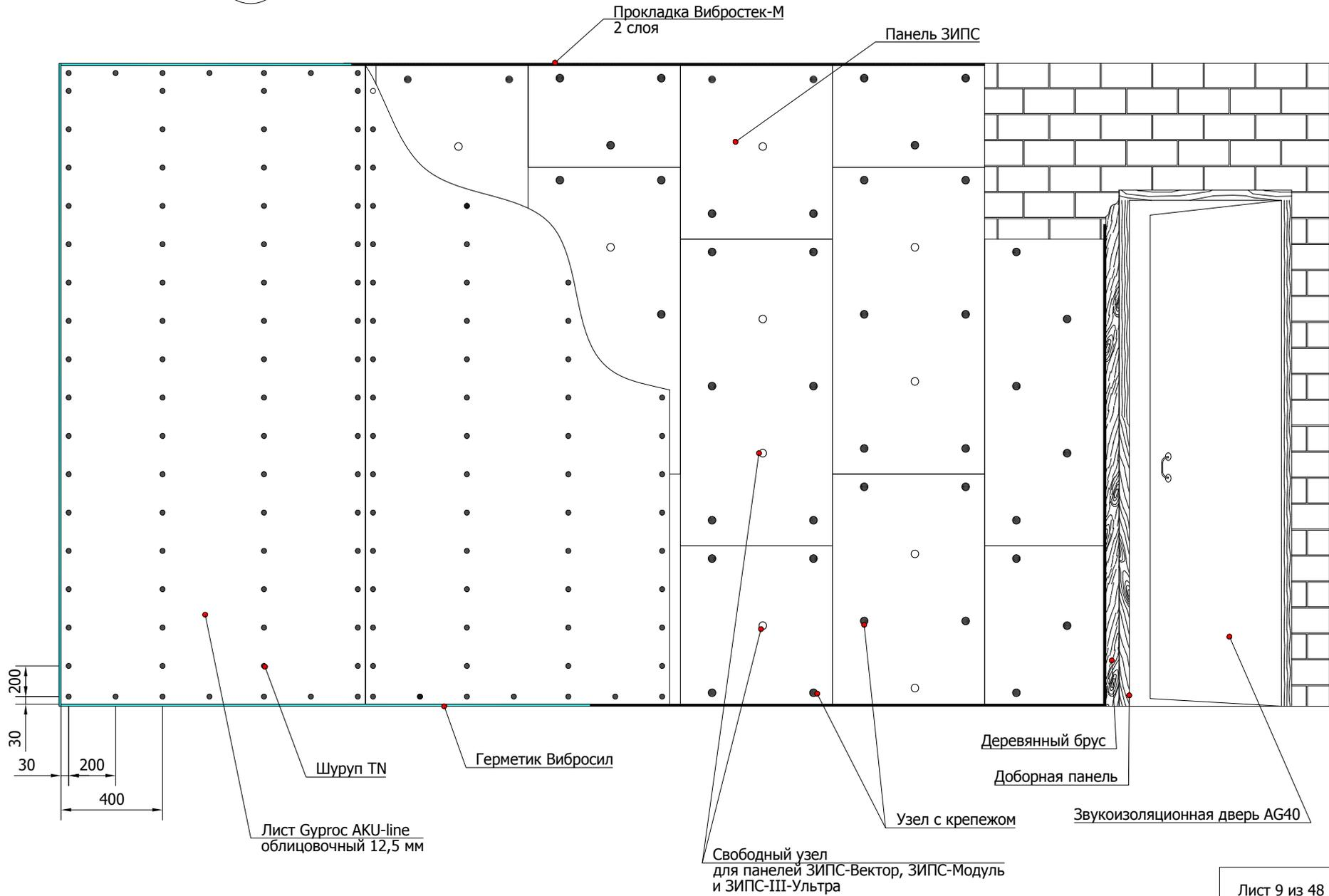
2.1.2 Монтаж панельной системы ЗИПС (вертикальный разрез)
