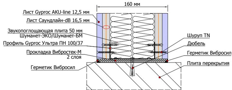
1.3.6 Примыкание перегородки на одинарном каркасе из профилей Виброфлекс-Wave 100 мм к стене и дверному проему
