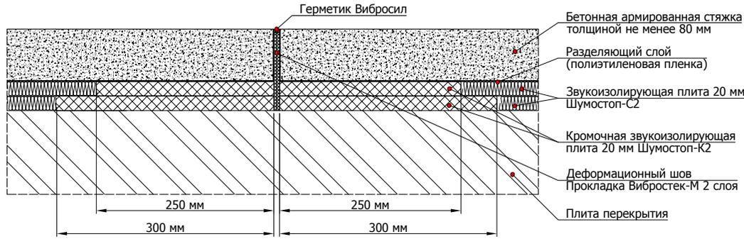
6.3.6 Схема примыкания конструкции плавающего пола с применением звукоизолирующих плит Шумостоп в два слоя к стене
