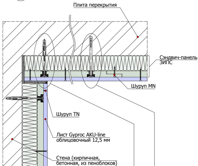
2.1.3 Монтаж панельной системы ЗИПС на внешний угол (горизонтальный разрез)
