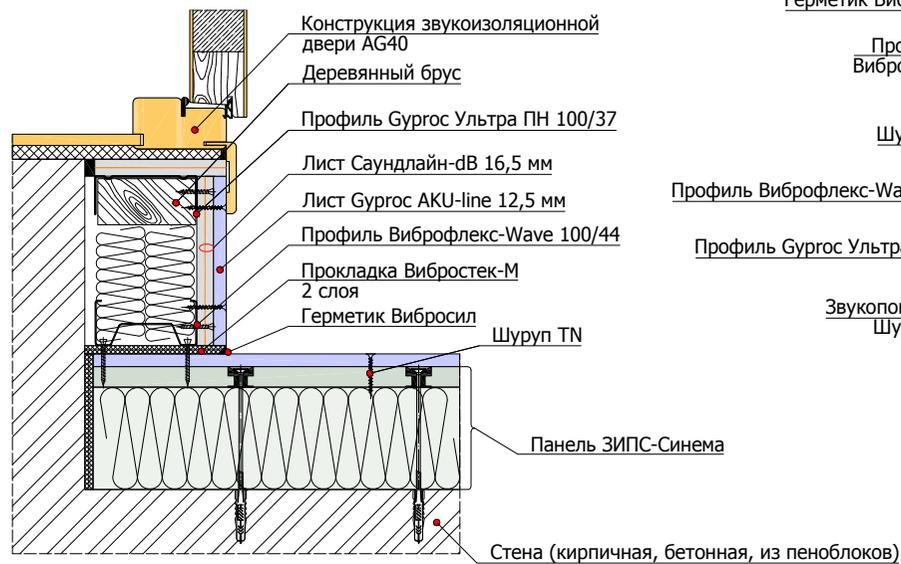
4.4.1 Примыкание облицовки стены на каркасе ПП 60/27 и виброизолирующих стеновых креплениях Виброфлекс-Коннект ПС к конструкции "плавающего пола"
