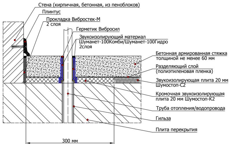
6.3.4 Схема примыкания конструкции плавающего пола с применением звукоизолирующих плит Шумостоп в один слой к стене и коммуникациями под стяжкой
