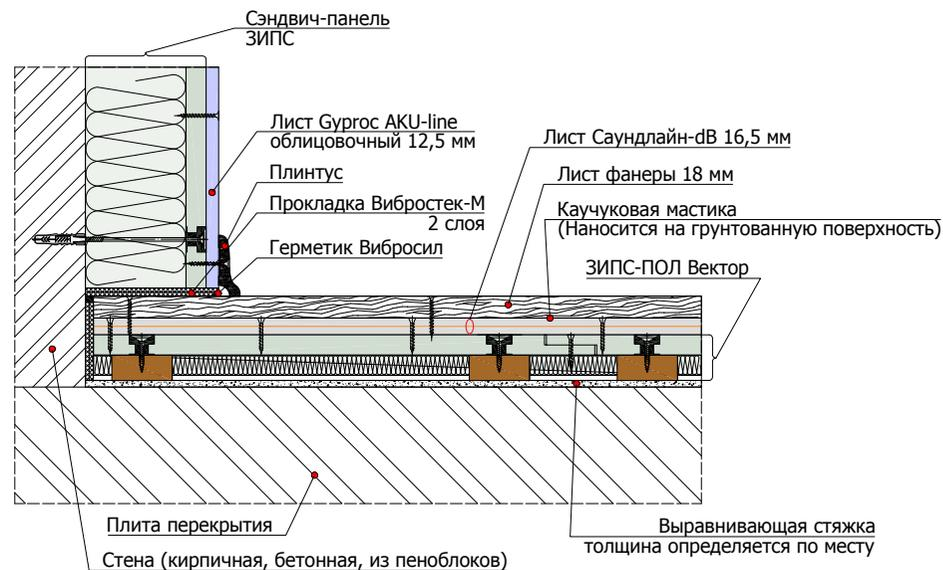
6.6.3 Схема примыкания конструкции ЗИПС-ПОЛ Вектор к стене и трубе отопления/водопровода (монтаж на ровное перекрытие)
