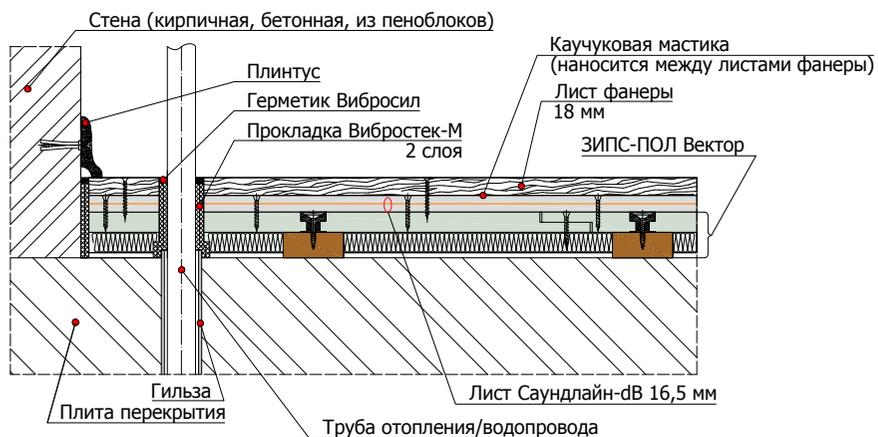
6.6.4 Схема примыкания конструкции ЗИПС-ПОЛ Вектор к каркасной облицовке
