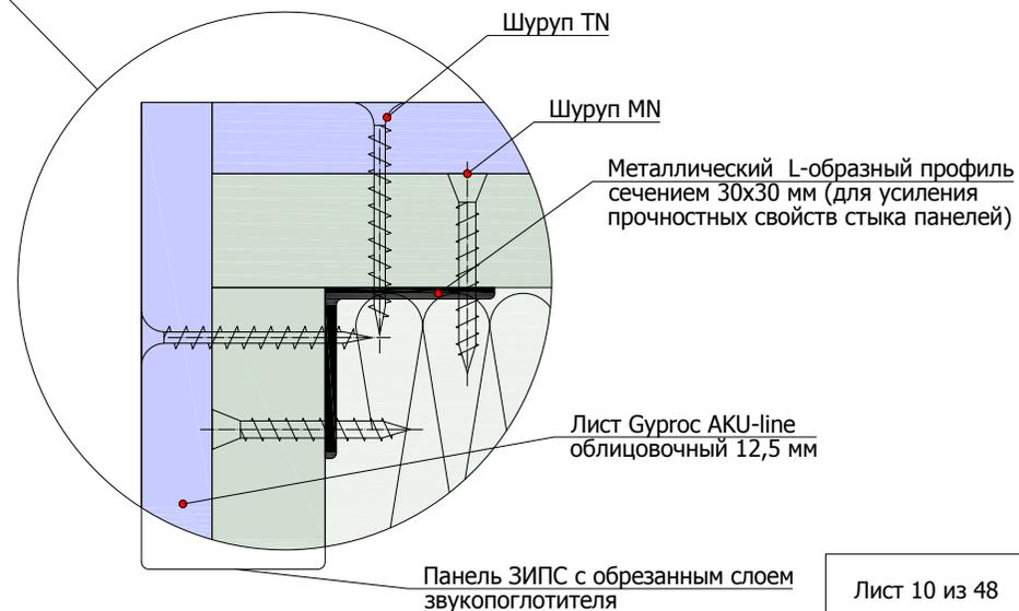
2.2.1 Примыкание панелей ЗИПС-Вектор к перекрытию пола/потолка
