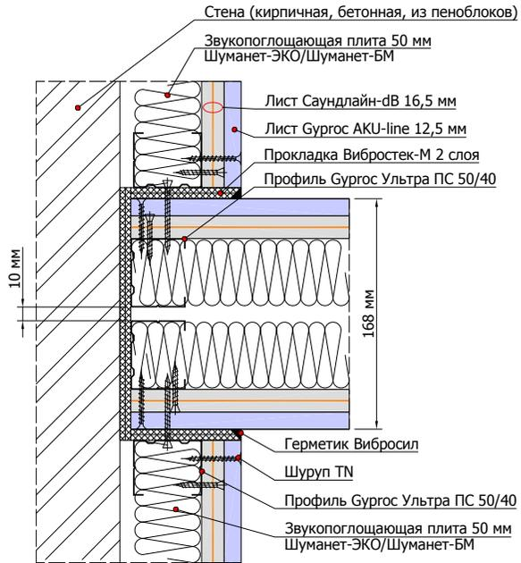
1.4.4 Примыкание перегородки на двойном 2x50 мм (сдвоенном независимом) каркасе к панелям ЗИПС на стене и дверному проему
