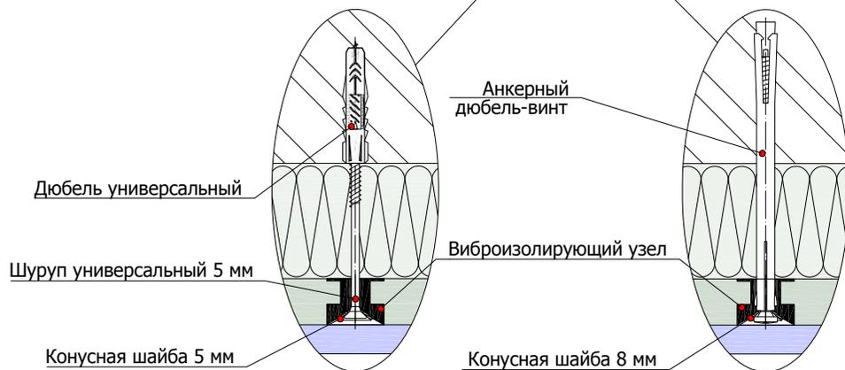
2.1.5 Узлы крепления панелей ЗИПС при монтаже внешнего угла
