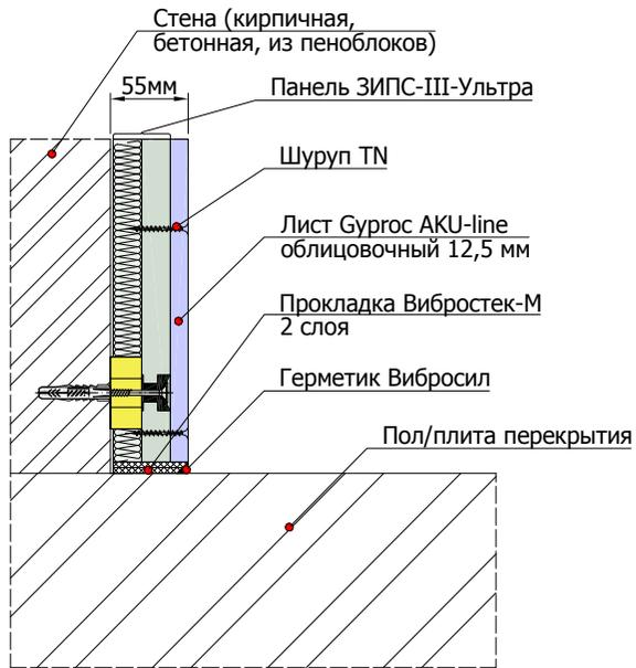
2.5.2 Примыкание панелей ЗИПС-III-Ультра к панелям ЗИПС-III-Ультра на потолочном перекрытии и подвесному звукоизолирующему потолку
