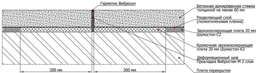
6.3.2 Схема примыкания конструкции плавающего пола с применением звукоизолирующих плит Шумостоп в один слой к стене
