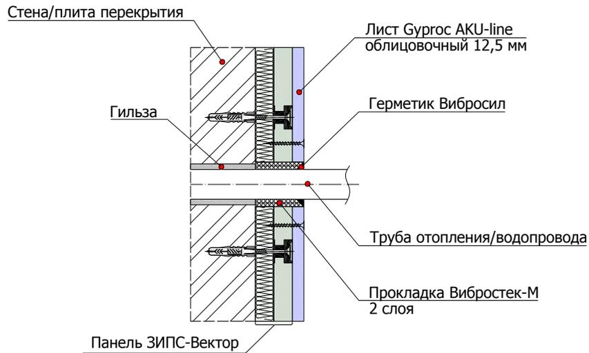
8.4.2 Схема пропуска труб отопления/водопровода через конструкцию панельной системы ЗИПС-Модуль
