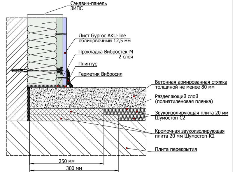
6.3.7 Схема примыкания конструкции плавающего пола с применением звукоизолирующих плит Шумостоп в два слоя к стене и трубе отопления/водопровода
