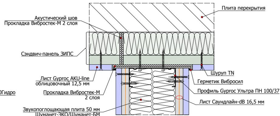
1.3.1 Примыкание перегородки на одинарном каркасе из профилей Виброфлекс-Wave 100 мм к облицовке стен
