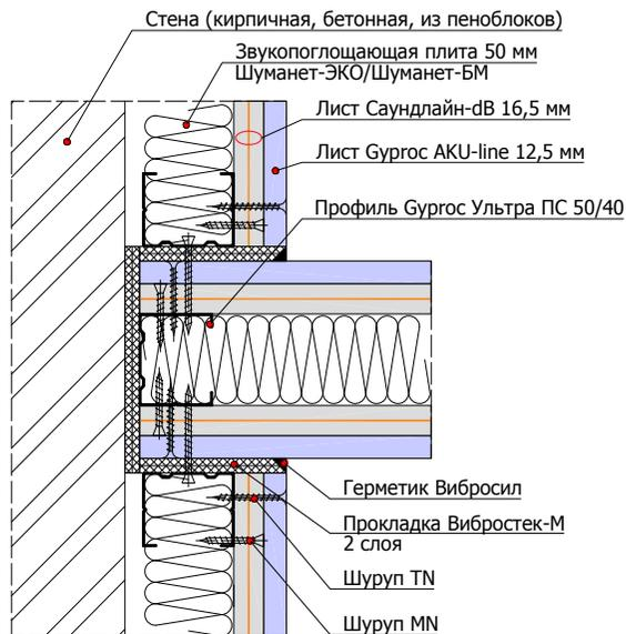
1.1.2 Примыкание перегородки на одинарном каркасе 50 мм к панелям ЗИПС на стене и дверному проему
