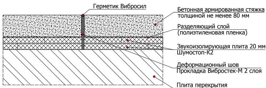
6.4.6 Схема примыкания конструкции плавающего пола с применением звукоизолирующих плит Шумостоп-K2 в два слоя к стене
