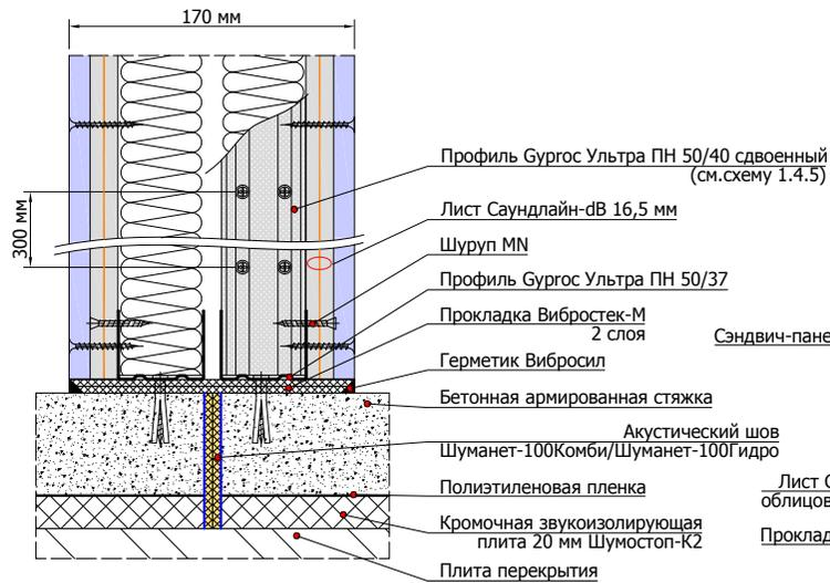
1.4.2 Примыкание перегородки на двойном 2x50 мм (независимом сдвоенном) каркасе к панелям ЗИПС
