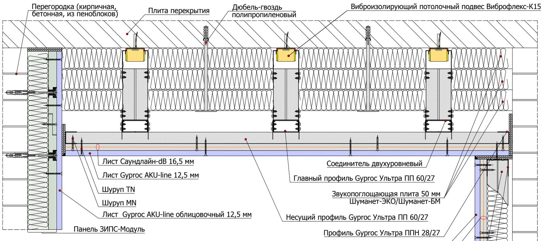
5.3.2 Вариант удлинения прямого подвеса профилем ПП 60/27 в конструкции звукоизолирующего потолка с применением виброизолирующих потолочных подвесов Виброфлекс-К15
