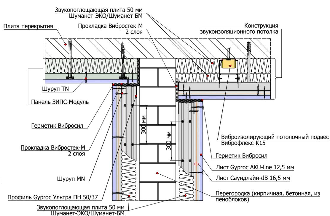
4.2.4 Облицовка стены на независимом сдвоенном каркасе 50 мм горизонтальный разрез
