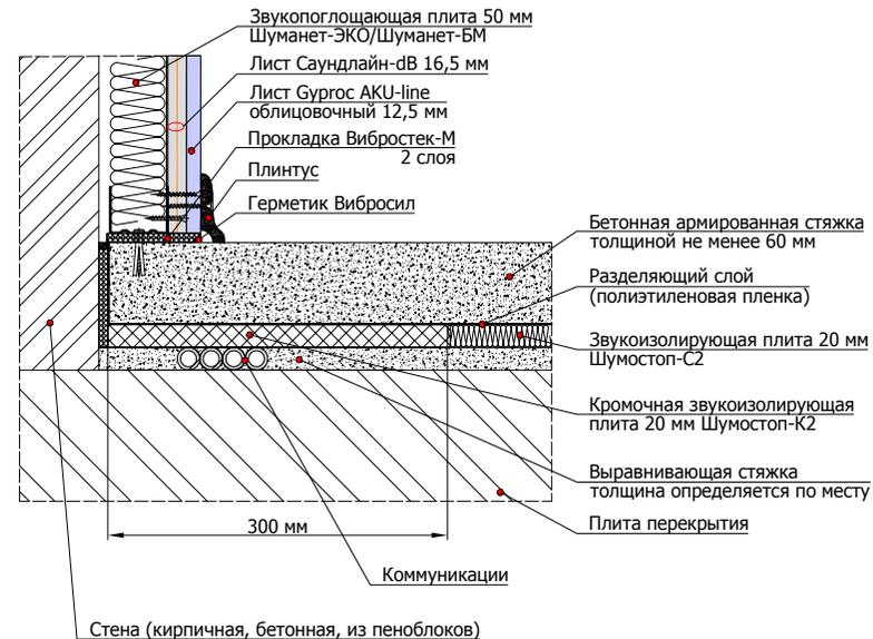
6.3.5 Схема устройства конструкции плавающего пола с применением звукоизолирующих плит Шумостоп в два слоя
