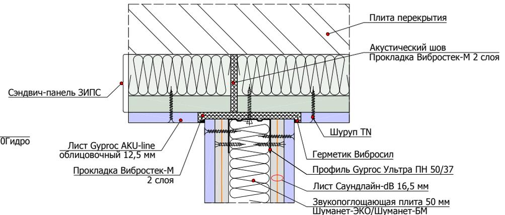
1.1.5 Примыкание перегородки на одинарном каркасе 50 мм к перекрытию пола/потолка
