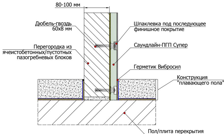
3.4 Примыкание конструкции "плавающего пола" к панелям Саундлайн-ПГП Супер, смонтированным на перегородку из полнотелых гипсовых пазогребневых блоков
