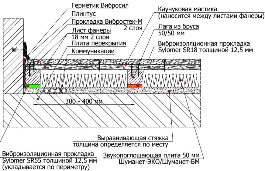
6.7.2 Схема примыкания конструкции пола по деревянным лагам с применением виброизоляционного материала Sylomer к панелям ЗИПС
