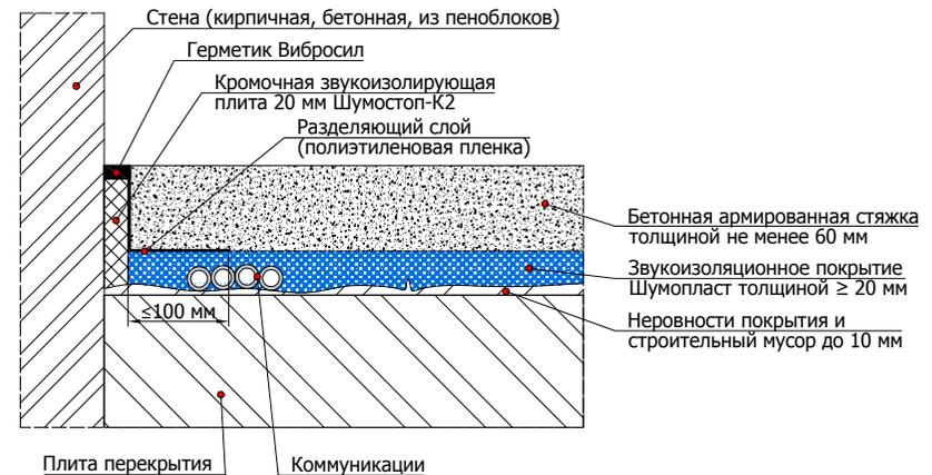
6.6.1 Схема устройства конструкции ЗИПС-ПОЛ Вектор
